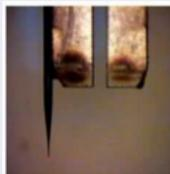
**FIGURE:** Dispositif de régulation sur les forces de cisaillement, shear forces avec diapason
